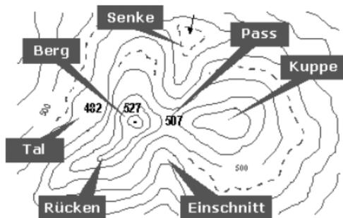
Aus dem Abstand der Höhenlinien zueinander ist ersichtlich, wie steil die Steigung bzw. das Gefälle ist. Geringe Abstände zwischen den Linien stellen somit ein steiles Gelände dar, sind die Höhenlinien weiter auseinander ist das Gelände flacher.
